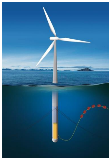
Figure 3-6. Overview (Vigara, y otros, 2019) and sketch of WindCrete platform (Mahfouz, y otros, 2020).
